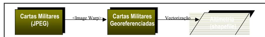
Fig. 4 - Fluxograma para obtenção de Altimetria
