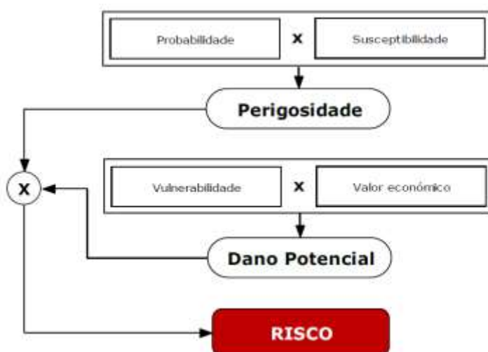
Figura 7 - Esquema de cartografia de risco, de acordo com o Guia Técnico (AFN, 2012)
