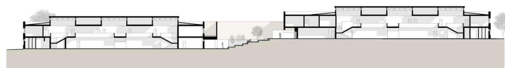
CORTE 2 - Escala 1:500 É mantido o lanternim que ilumina naturalmente os espaços de distribuição interiores
