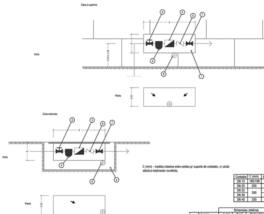
C (mm) - medida máxima entre uniões p/ suporte de contador, c/ união elástica totalmente recolhida.
